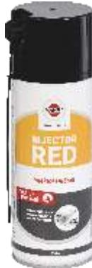
MAKRA RED je vhodný na demontáž zapečených, zoxidovaných a zkarbonizovaných částí motorů (vstříků, vstřikovacích trysk, svíček, žhavicích svíček). Díky podchlazení materiálu na -40°C a následnému CRACK efektu, dojde ke smrštění materiálu a vzniku malých trhlin, kterými perličky PTFE proniknou (pomocí vysoce vzlínavého syntetického oleje) přímo na postižené místo a umožní jeho uvolnění.
